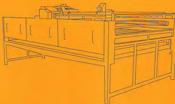
Los consumos de luz y agua dependerán de las dimensiones de las máquinas, pues existen modelos de anchura, en función del paso de fruta, de 750mm, 1000 mm, 1250mm, 1500mm, 1750mm o 2000mm, así como longitudes varias según necesidades del cliente.
